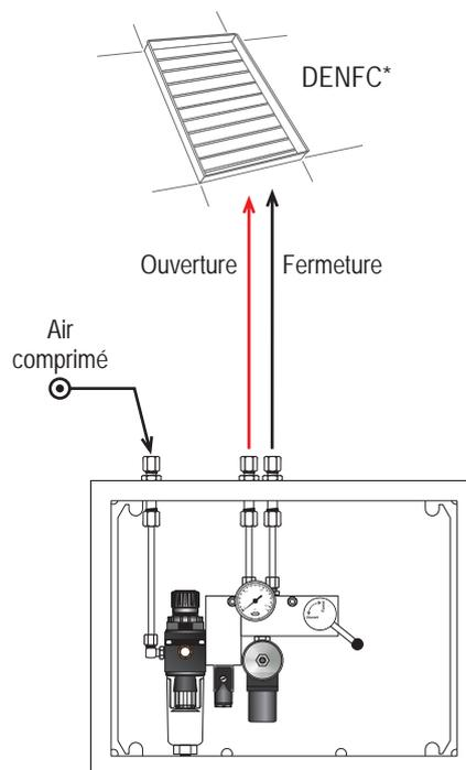
UTILISATION DU CONTACTEUR POUR DONNER UN ORDRE DE FERMETURE EN CAS DE BAISSÉ DE PRESSION D'ALIMENTATION DU COMPRESSEUR
