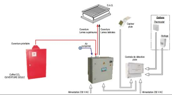
EXEMPLE D'INSTALLATION POSSIBLE AVEC UN COFFRET TYPE 3673 avec centrale pluie
