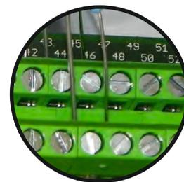
Il est possible de raccorder un ordre de fermeture générale à la centrale COMPACT permettant la fermeture manuelle ou automatique (avec une horloge) d'ouvrants commandés électriquement dans le mode confort (aération).
