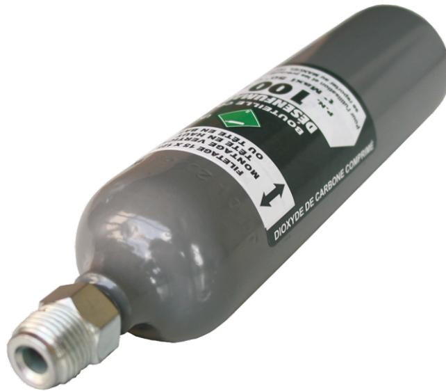
Les bouteilles de CO<sub>2</sub> sont constituées d'un réservoir et d'une tête filetée avec opercule perforable. Elles contiennent du dioxyde de carbone comprimé à 60 bar à une température de 20°C environ, en équilibre phase liquide/phase gazeuse.
